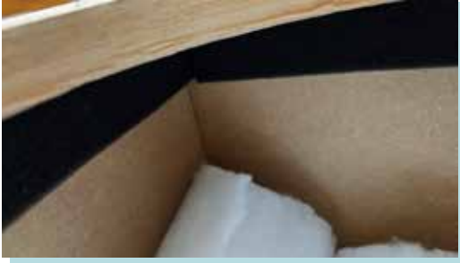
スピーカーユニットとの距離が近い隅には防振テープを貼って極力スピーカー正面への干渉を防ぐのが狙い。家に転がっていた廃材を使用。
