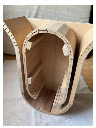
曲面部分は、MDFに溝を入れ接着剤を流し込んで曲げて固定する方法で実現しています。曲げ角度によって12mm厚と4mm×2枚重ねを使用。
